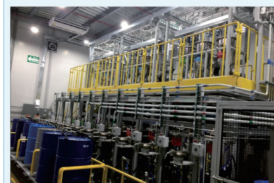
出口至墨西哥 多元醇自动预混系统 Export to Mexico Automatic pre-mixing system for polyols
